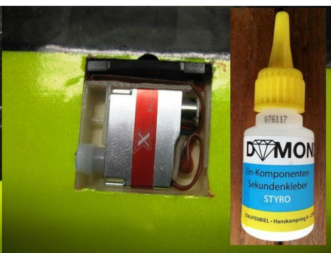
Připravený konektor na připojení serva. Připojené servo, poskládaný kabel v připravené mezeře. Bezpatkové servo i rámeček jsou lepeny CA lepidlem na styro!!!
