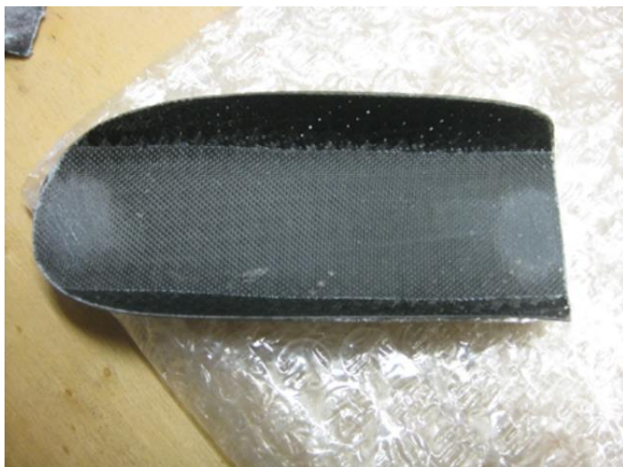
Zdrsněte místa kabiny pro lepení magnetů
