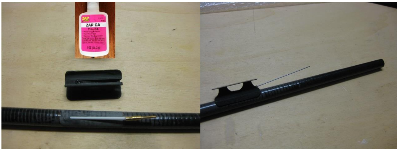
Lepení kozlíku CA lepidlem, možno i epoxidem
