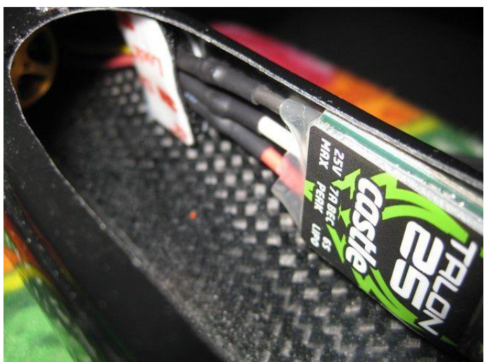
Regulátor přilepen na 3M Dual Lock.
