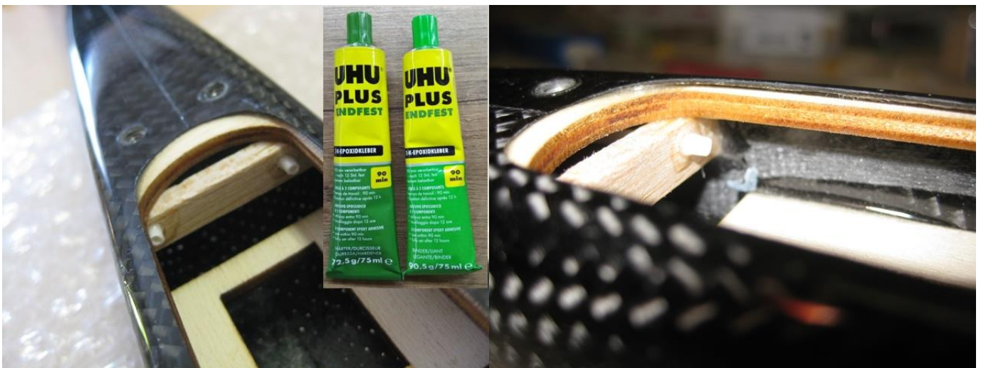
Přilepená přepážka epoxidem a zkrácení bowdenů
