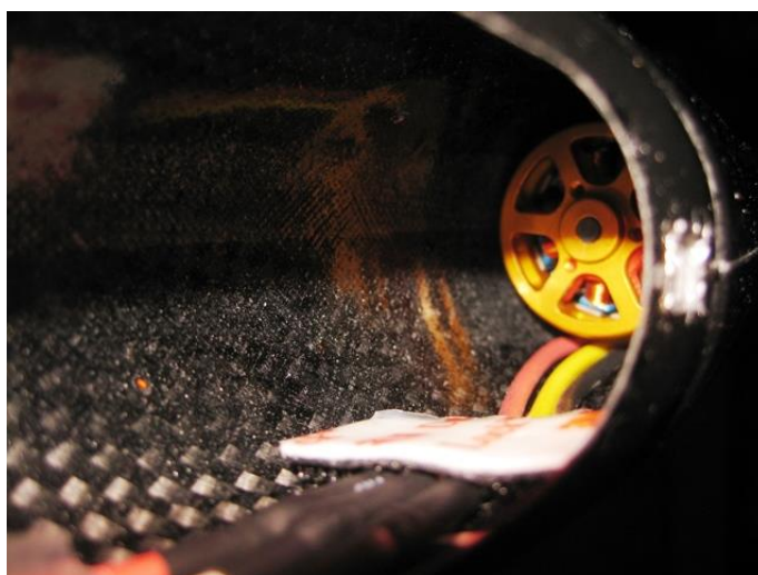
Kabely také zajištěny 3M Dual Lock
