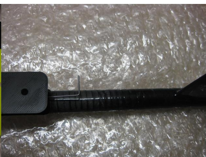
„L“ ohyb je dostačující, drát pak nemá kam vypadnout
