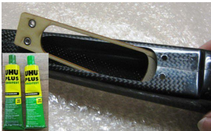
Vložení do trupu a lepeno epoxidem
