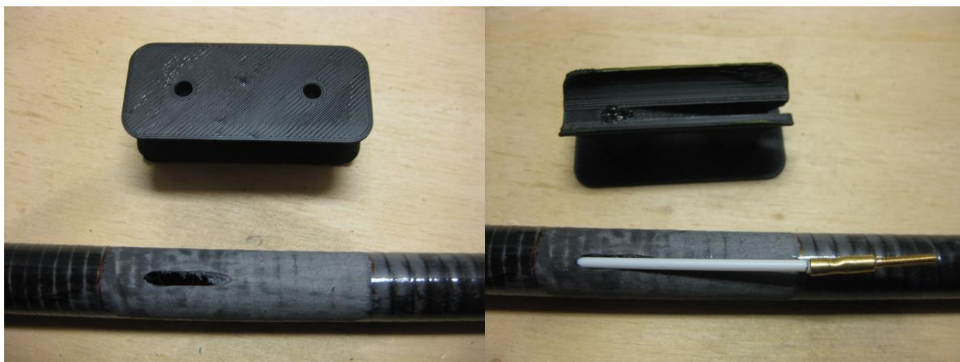
Zdrsňení před lepením a příprava pro bowden
